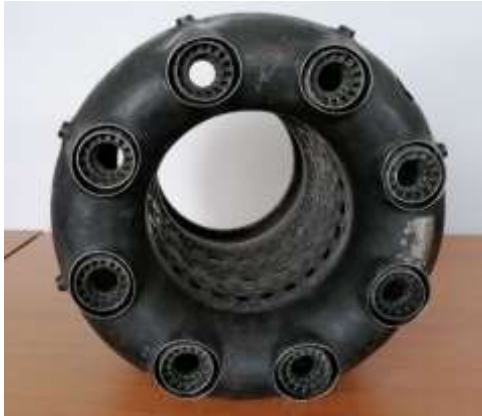
1.ábra: TV2-117A hajtómű égőterének tűzcsöve (baloldalt) és annak centrálisan szimmetrikus részletének CAD alapú rajza (Készítette: Sári János)
