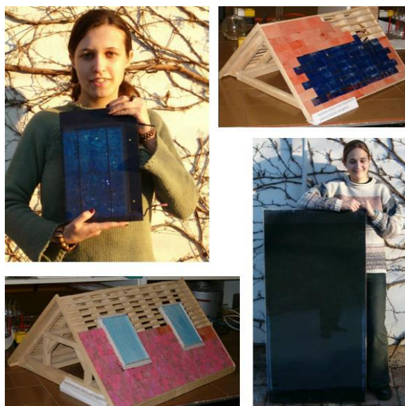
5. ábra: Felső sor: napelemes pikkellyfedés; alsó sor: fedés napelemtáblákkal (Nemesics et al. 2008)
