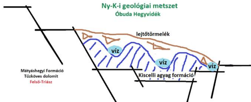
6. ábra: Magyarázó metszetrajz területünk talajvíz viszonyairól (saját szerkesztés)
